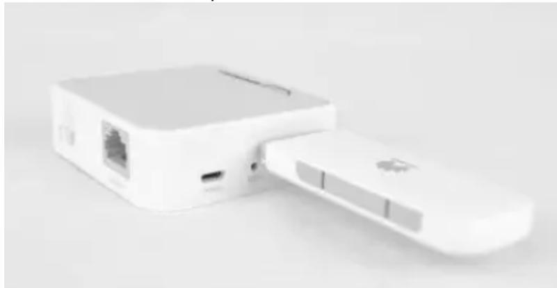
2. **Alimentez** le port mini-USB **Power** du routeur sur le secteur (ou sur un port USB d'un ordinateur).
